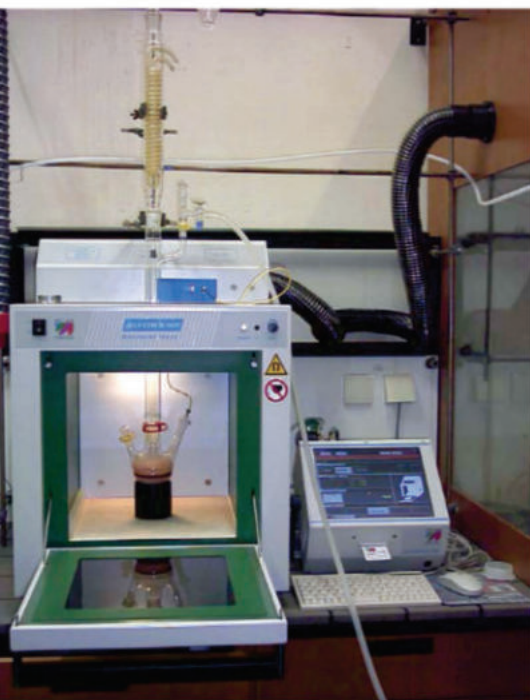
Bild 1: Mikrowellenreaktor mit einem Behälter für hohe Drücke bis 199 bar und 300 °C. Bild: Dr. Eberhard Heller
